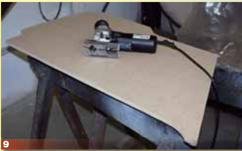
9 Die Schablone legt man auf eine MDF-Platte, zeichnen die Konturen nach und sägt die Seitenwand mit einer Stichsäge aus
