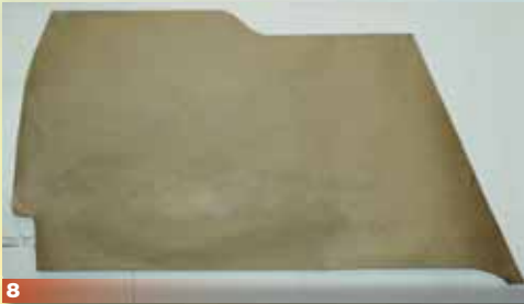
8 Das Papier wird ausgeschnitten und so erhält man eine Schablone für die neue Seitenwand aus MDF, auf deren Rücken später das Formteil laminiert werden wird
