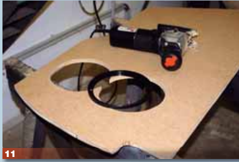
11 Da die Woofer samt Gitter versenkt eingebaut werden sollen, sägt man die Löcher so groß, dass die Gitter mit leichtem Spiel (für den Bezugsstoff) hineinpassen
