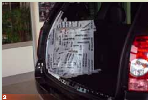
2 Die Mulde wird mit Paketband abgeklebt. Um die abgeklebte Mulde werden Kunststofffolien geklebt, um angrenzende Flächen zu schützen
