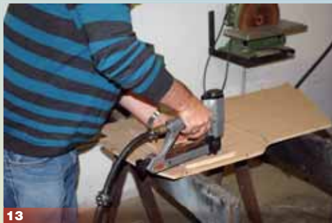
13 Jetzt wird die kleinere MDF-Platte von hinten auf die Seitenwand geleimt und genagelt (oder verschraubt)
