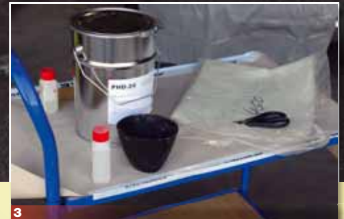
3 Die Glasfasermatten werden zurechtgeschnitten und das Kunstharz in kleinen Mengen angerührt, damit es nicht vorzeitig aushärtet. Es sollte auf keinen Fall hinter hervorstehenden Teilen laminiert werden, da sonst die ausgehärtete Form nicht mehr aus der Mulde zu entfernen ist!
