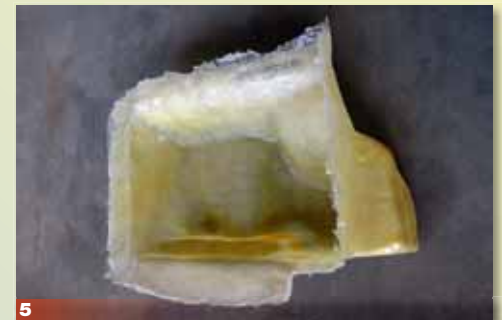
5 Das ausgehärtete Formteil und alle Folien und Klebebänder werden aus der Mulde entfernt, und das Formteil von Klebebandresten befreit
