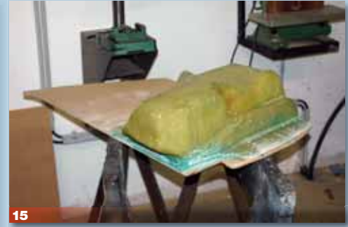
15 Jetzt wird das GFK-Formteil von hinten auf das Seitenteil laminiert. Dabei ist darauf zu achten, dass die Form von hinten nicht verändert wird, da sie sonst nicht mehr in die Kofferraummulde passt
