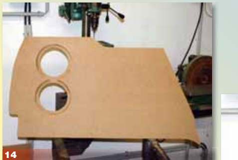
14 Das Ergebnis ist eine Seitenwand mit zwei versenkten Einbauöffnungen für die Subwoofer. Nur der Ausschnitt fürs Reflexrohr fehlt noch
