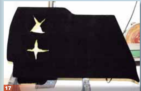
17 Der Teppich wird dort ausgeschnitten, wo später die Lautsprecher und das Reflexrohr sitzen werden. Überschüssiger Filz in den Löchern wird mit dem Cutter entfernt
