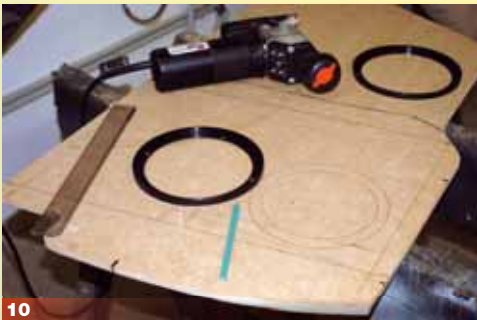
10 Jetzt werden die Positionen der Subwoofer und des Reflexrohrs bestimmt. Es soll gefällig aussehen, jedoch ist auf die Einbautiefe der Woofer und des Rohrs zu achten
