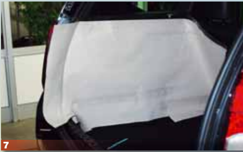
7 Auf das Originalseitenteil wird ein großer Papierbogen gelegt und die Konturen werden mit einem Bleistift nachgezeichnet
