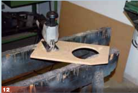
12 Damit die Woofer nicht durch ihre Löcher fallen, entsteht eine kleinere MDF-Platte, die als Schallwanddupplung den Woofern Halt gibt
