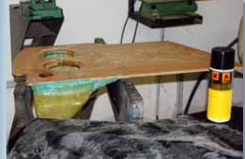
16 Nun sprühen wir das Seitenteil und den Rücken des Teppichs mit Kleber ein, lassen den Kleber etwas lüften und verkleben anschließend das Seitenteil mit dem Teppich. Dabei ist darauf zu achten, dass der gelüftete Kleber jetzt ein Kontaktkleber ist, der (fast) nicht korrigierbar ist! Sorgfältiges Arbeiten ist also angesagt
